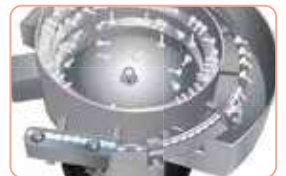
Εποπτεία ορθού προσατολισμού σε τροφοδοτές εξαρτημάτων γραμμής συναρμολόγησης
