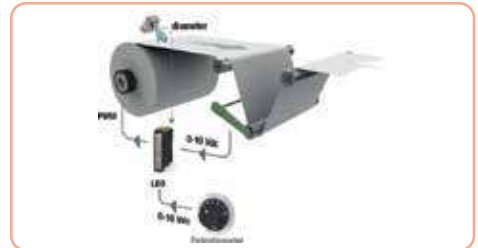
Έλεγχος τάσης για πολύ γρήγορη προσαρμογή, ανάλογα με τη διάμετρο και με χρήση μπαλαρίνου, σε εφαρμογή εκτύλιξης
