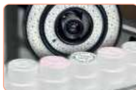
Επιθεώρηση ετικετών σε πολύ υψηλή ταχύτητα με χρήση flash τύπου ring
