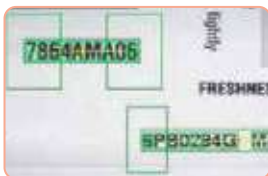
Αναγνώριση αλφαριθμητικών χαρακτήρων και έλεγχος δεδομένων
