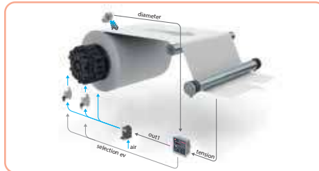
Έλεγχος τάσης για πολύ γρήγορη προσαρμογή, ανάλογα με τη διάμετρο και με δυναμοκυψέλη ζύγισης, σε εφαρμογή εκτύλιξης
