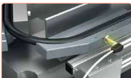
Ανίχνευση πλαστικού σωλήνα κατά τη διαδικασία συναρμολόγησης
