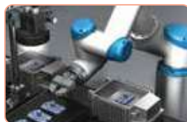
Τοποθέτηση προϊόντων από ρομποτικό βραχίονα
