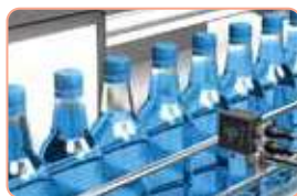
Έλεγχος στάθμης με χρήση backlight
