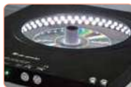
Χρήση darkfield light για εξελιγμένα συστήματα πιστοποίησης ποιότητας
