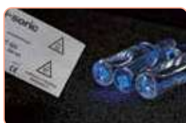
Αναγνώριση αόρατης μελάνης με φωτισμό UV στη βιομηχανία φαρμάκων
