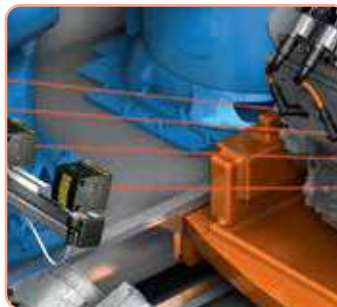
Έλεγχος θέσης για τοποθέτηση εξαρτήματος σε αυτόματη γραμμή συναρμολόγησης
