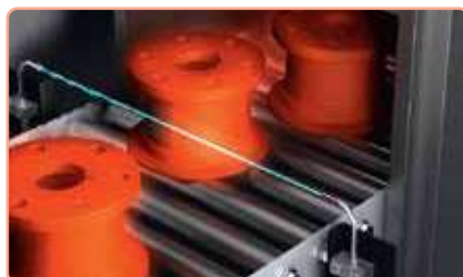
Ανίχνευση με οπτική ίνα υψηλής θερμοκρασίας
