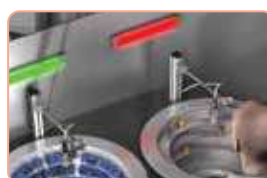
Ένδειξη κατάστασης μηχανών με τη χρήση 3 χρωμάτων
