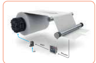
Έλεγχος τάσης κλειστού βρόχου, με δυναμοκυψέλη ζύγισης
