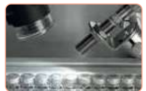
Ανίχνευση απουσίας πομπών με κάμερα και χρήση spotlight
