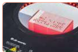
Εύκολη ανάγνωση ανάγλυφου κώδικα με χρήση darkfield light
