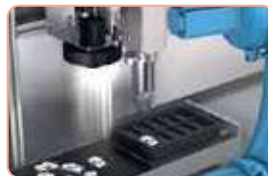
Αυτόματος προσατολισμός και τοποθέτηση προϊόντων από ρομποτικό βραχίονα
