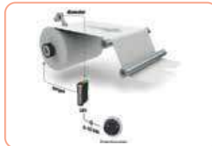
Έλεγχος τάσης ανοικτού βρόχου, ανάλογα με τη διάμετρο
