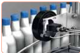
Έλεγχος σωστής τοποθέτησης πάματος σε γραμμή εμφιάλωσης
