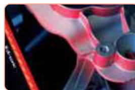
Εύκολη παρατήρηση, αυξάνοντας τις αντιθέσεις με χρήση barlight
