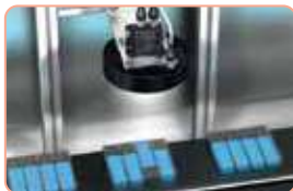
Έλεγχος ορθής τοποθέτησης προϊόντων εντός της συσκευασίας
