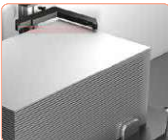
Έλεγχος ύψους στοιβάς για τον άμεσο ανεφοδιασμό
