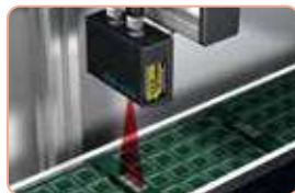
Αναγνώριση εξαρτημάτων με ανάγνωση γραμμοκώδικα (barcode)
