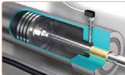
Ανίχνευση βάρικου σε υδραυλικό έμβολο 500 bar
