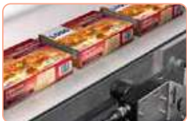
Ανάγνωση και επαλήθευση κειμένου σε γραμμή συσκευασίας
