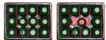
Παράδειγμα ελέγχου πλήρωσης κιβωτίου με φιάλες
