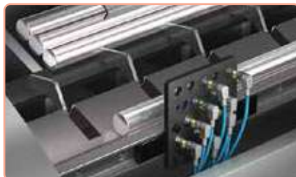
Επιβεβαίωση σωστής θέσης περιστρεφόμενου εργαλείου και ενεργοποίηση μηχανισμού κλειδώματος
