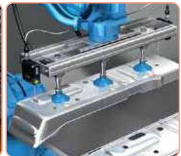
Προσαρμογή ταχύτητας αναρρόφησης ανάλογα με την απόσταση για την βελτιστοποίηση του χρόνου εργασίας
