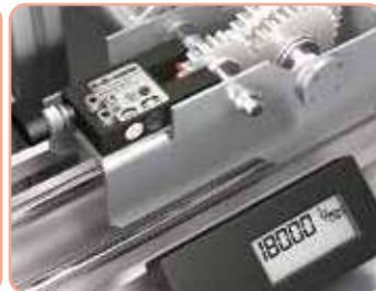
Μέτρηση της ταχύτητας των μικρών πλαστικών γβαναζιών
