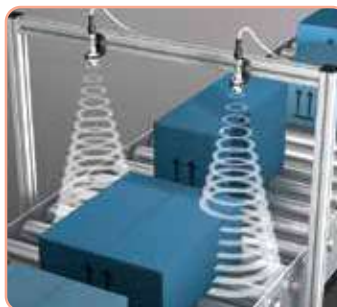
Αξιοπίστη μέτρηση διαφορετικού ύψους κουτιών ανεξάρτητα των διαφορετικών ιδιοτήτων τους
