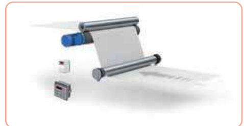
Έλεγχος τάσης με κινητήρα και απευθείας έλεγχος γραμμικής κίνησης
