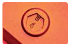
Αύξηση αντιθέσεων σε γυαλιστερά αντικείμενα με χρήση coaxial light
