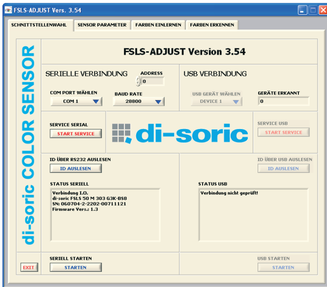
SCHNITTSTELLENWAHL / SELECT CONNECTION: Grundeinstellungen der Sensorverbindung auswählen. Selecting the basic settings for the sensor connection.
